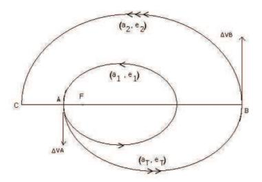
$\textbf{Figure 1} \ \textbf{Apogee} \ \textbf{of} \ \textbf{transfer} \ \textbf{orbit} \ \textbf{coincides} \ \textbf{with} \ \textbf{apogee} \ \textbf{of} \ \textbf{final} \ \textbf{orbit}. \\ \textbf{(Initial impulse at perigee)}$
